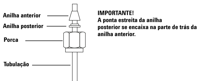
Figura 9 Porcas e anilhas Swagelok
